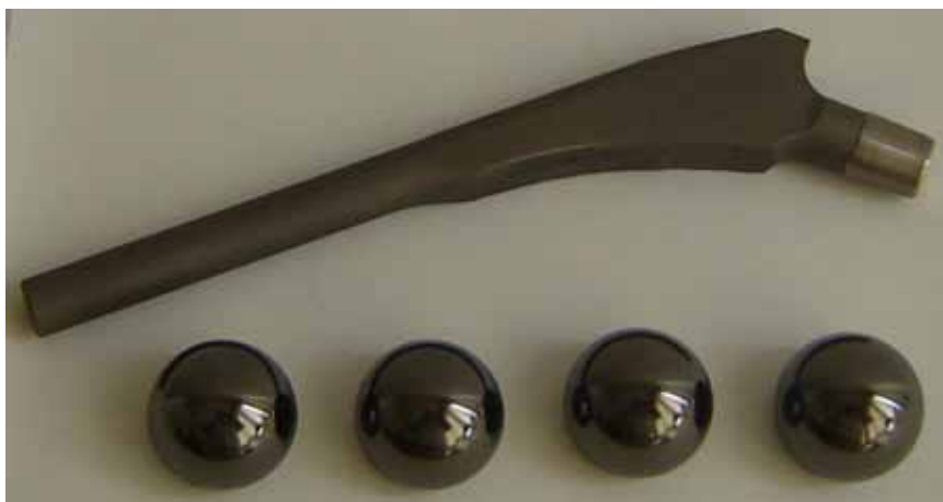
Образци на глави за ендопротези, изработени по описаната технология
