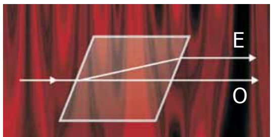
Схема на двойно лъчепречупващ монокристал
