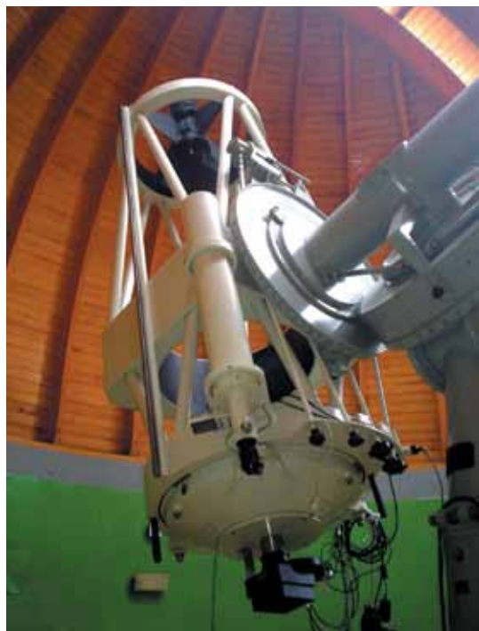
60 см Касегрен телескоп в НАО. Неговата зрителна тръба е конструкция тип Серюре (Serrurier). Съставена е от централен пояс, към който чрез тръбна конструкция са прикрепени заден и преден пръстен, носещи съответно главното и вторичното огледало
