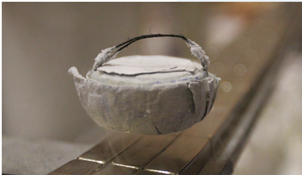
Fig. 3. Superconductor de alta temperatura, enfriado con nitrógeno líquido
