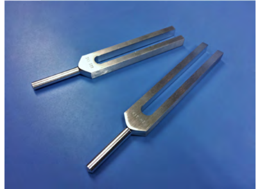
Fig. 1. El diapasón normal vibra con una frecuencia determinada
