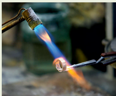
Soldadura con acetileno
