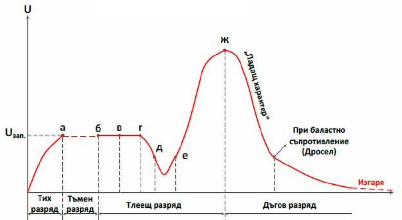
Фиг. 2. 6. Волт-амперна характеристика при електролуминесценция <4>
