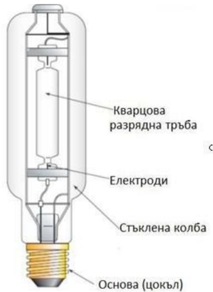
Фиг. 14.1. Общ вид на метал- халогенната лампа (4)
