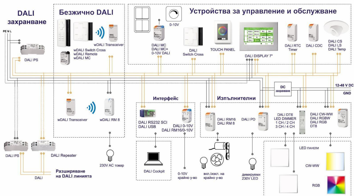
Фиг. 34.6. Принципна схема на DALI система
