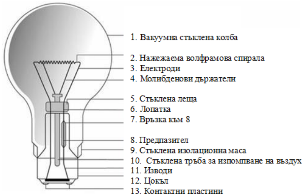
Фиг. 8. 1. Принципното устройство на лампа с нажежаема спирала (41)
