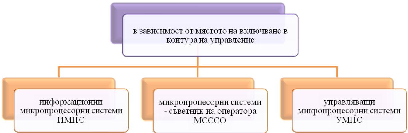
фиг. 286. Видове микропроцесорни системи
