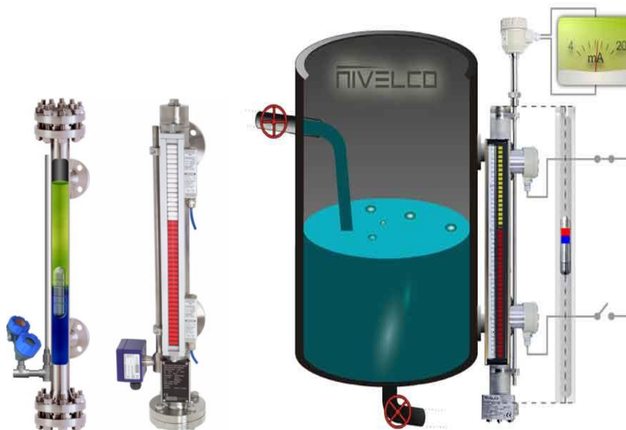
фиг. 63. Поплавъчен магнитен индикатор с байпасна камера [40, 41]
