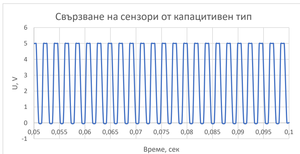
фиг. 213. Изходен честотен сигнал от схемата за свързване на капацитивния сензор
