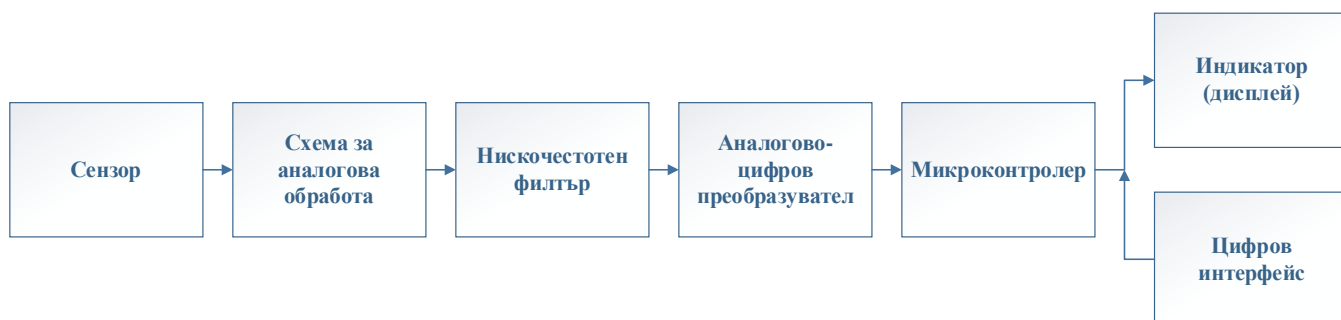
фиг. 202. Основни елементи на една измервателна система
