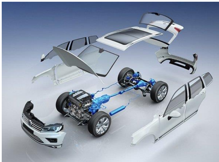
фигура 6.13. Разпределение на задвижване 4 Motion
