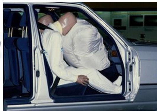
фигура 6.7. Действие на въздушните възглавници при челен удар
