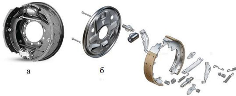
фигура 4.4. Челюстна спирачка: а – общ вид, б – в разглобено състояние
