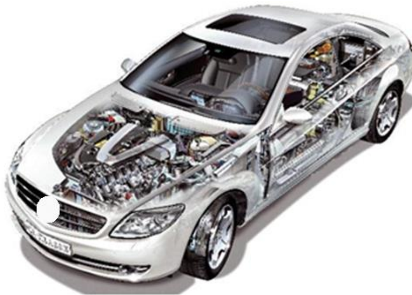
фигура 1.30. Общ вид и разположение на основните части на лек автомобил
