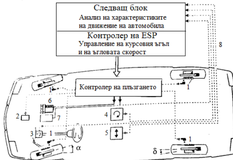
Фигура 6.12. Обобщена система за управление на ESP: 1 – преобразувател за ъглова скорост на колелата, 2 – преобразувател за налягане в спирачната система, 3 – преобразувател за положение на кормилното колело, 4 – преобразувател за ъглова скорост на автомобила спрямо вертикалната ос, 5 – преобразувател на напречно ускорение, 6 – модулатор за налягане, 7 – управление на работата на двигателя, 8 – сигнали на преобразувателите за ESP, \delta – ъгъл на увеличаване на гумата, \alpha – ъгъл на завиване на предното колело
