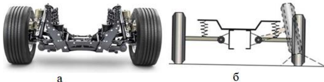
фигура 3.18. Независимо окачване: а – общ вид, б – схема
