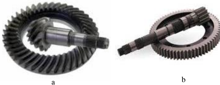
фигура 2.26. Главна предавка: а – хипоидна зъбна двойка, б – цилиндрична зъбна двойка
