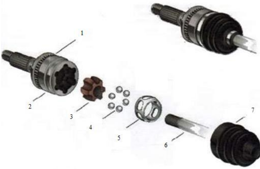
фигура 2.22. Синхронен карданен съединител: 1 – зъбен венец, 2 – профилен корпус, 3 – профилна муфа, 4 – сферични тела, 5 – сепаратор, 6 – карданен вал, 7 – гумен манион
