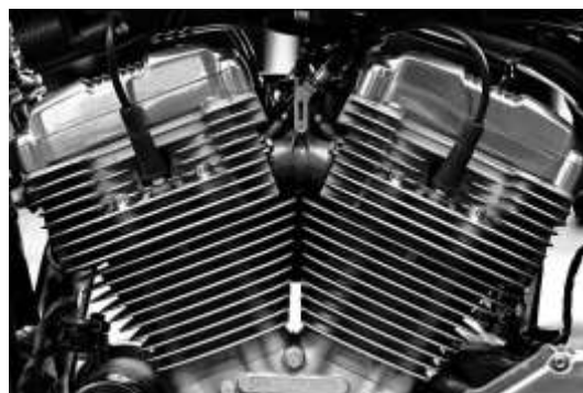
Фиг. 3.3.1. Въздушна охлаждаща система на мотоциклет
