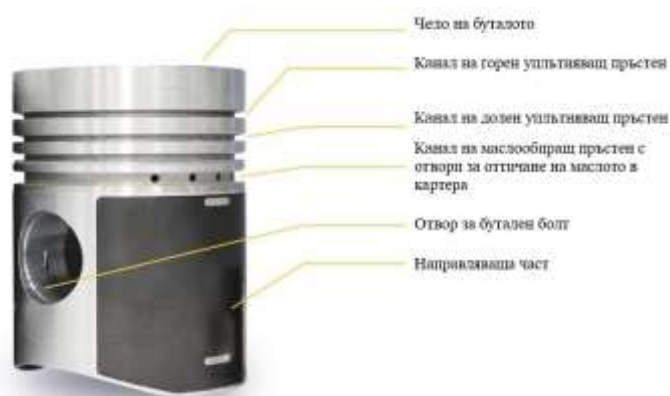
Фиг. 2.5.1. Части на буталото
