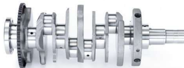
Фиг. 2.7.2. Непълноопорен колянов вал
