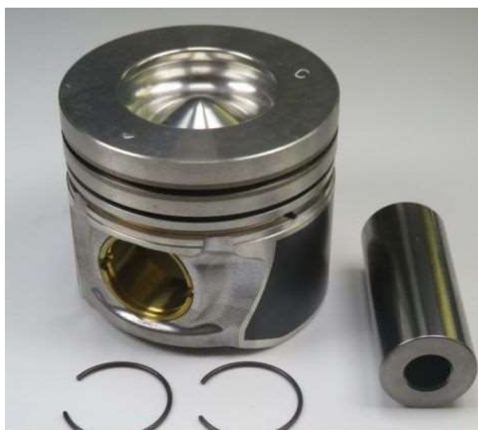
Фиг. 2.5.5. Бутало , бутален болт с осигурителни шайби
