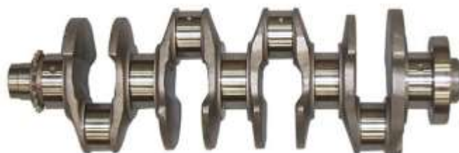
Фиг. 2.7.3. Пълноопорен колянов вал
