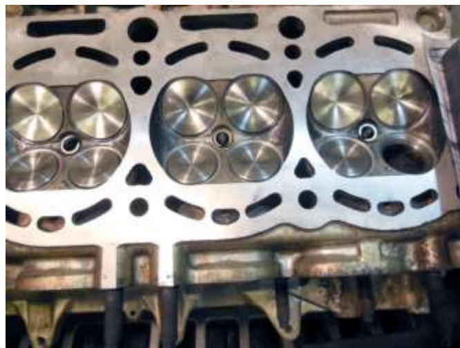
Фиг. 2.4.4 Горивни камери, клапани и отвори за охлаждаща течност и масло
