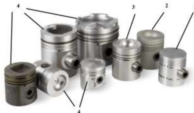
Фиг. 2.5.2. Бутала с различна конструкция на челото.
