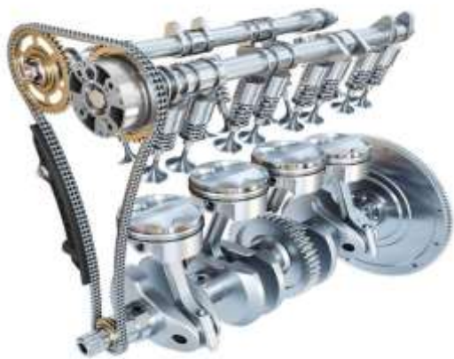
Фиг. 2.7.4. Монтажна схема на колянов и разпределителен вал
