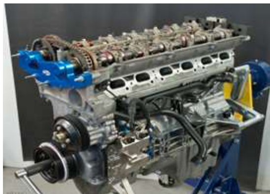
Фиг.1.2.2 Многоцилиндров двигател с 2 разпределителни вала
