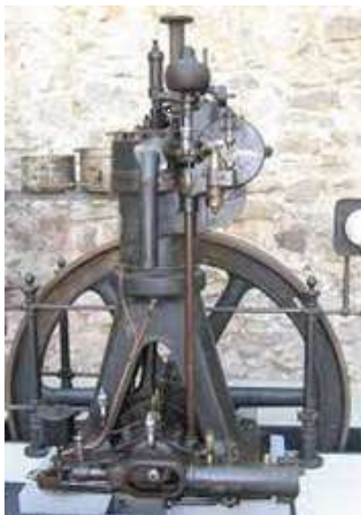
Фиг.1.1.3 Стационарен едноцилиндров двигател на Дизел MAN – 12 hp, 1906 г.
