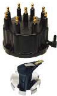
Фиг. 5.8.3. Прекъсвач (ляво) и дистрибуторна капачка с палец (вдясно)
