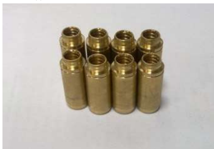
Фиг. 2.10.3. Направляващи втулки (водачи)
