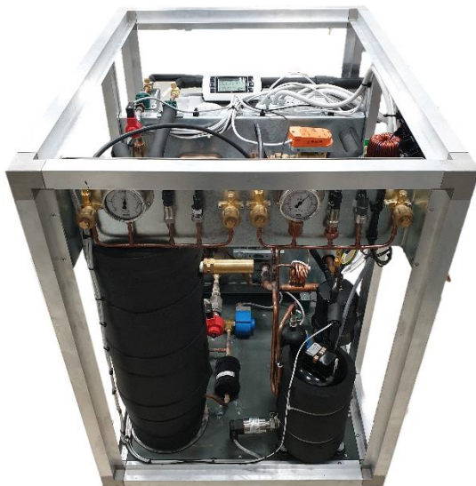
Фигура 9.4 Транскритична термopомпена система за загряване на вода за битови и технологични цели, работеща с CO 2
