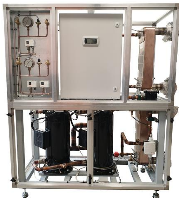
Фигура 7.2 Термopомпа вода-вода, работеща с R134a
