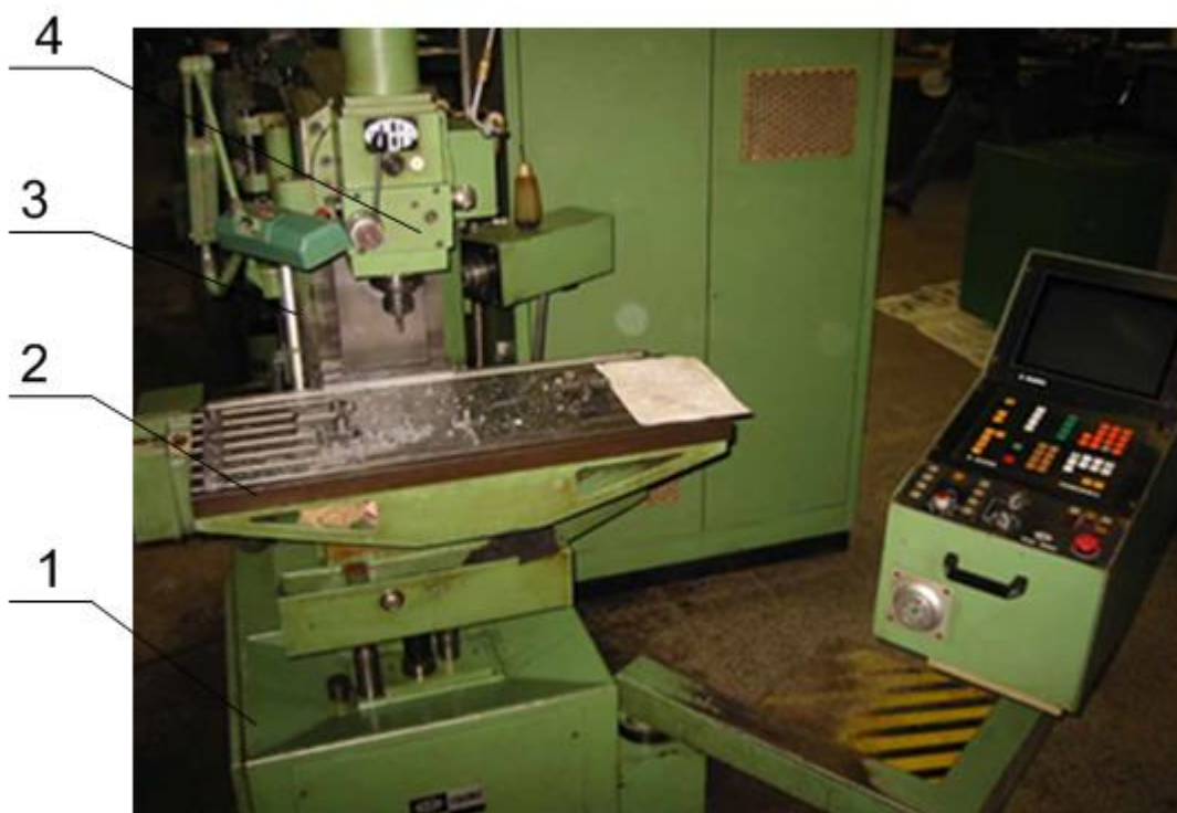
Фиг. 6.43. Координатно-пробивна машина: 1- тяло на машината; 2 - координатна маса; 3 – вертикална колона; 4 – пробивен супорт
