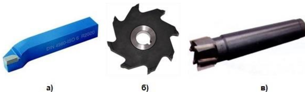
Фиг.2.5. Конструкции режещи инструменти с различни присъединителни части:
