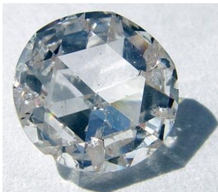
2.4. Синтетичен диамант получен чрез процеса на отлагане на пари
