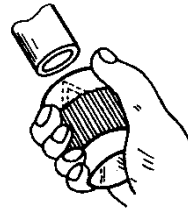
Фиг. 1. 18. Шабароване (почистване) на краищата на отрязана тръба
