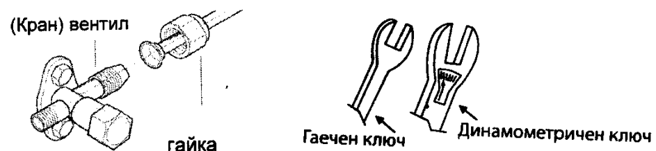
Фиг. 1.15. Центроване на тръба – нипел
