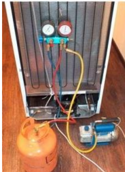
Фиг. 2.13. Начин на свързване на специализирани уреди и инструменти за вакуумиране и зареждане с хладилен агент на домашен хладилник
