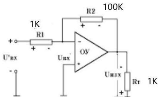
Под операционен усилвател (ОУ) се разбира постояннотоков усилвател с диференциален вход, много голям коефициент на усиливане по напрежение, много голямо входно съпротивление, много малко изходно съпротивление и неограничена честотна лента. Винаги се използват с някакъв вид обратна връзка, която определя параметрите и характеристиките на реализираната с тях схема.
