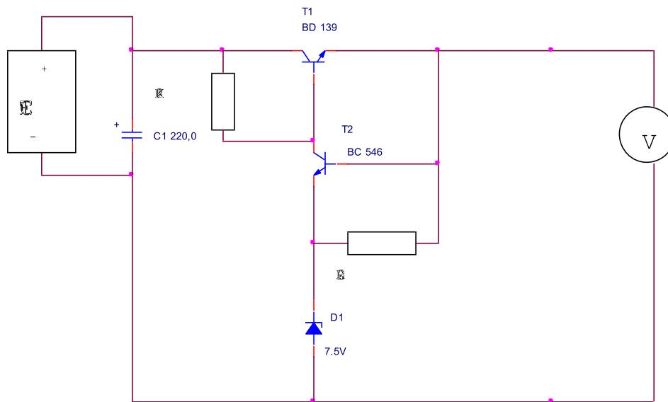
Компенсационните стабилизатори на постоянно напрежение представляват затворена система за автоматично регулиране. В зависимост от мястото на включване на регулиращия елемент по отношение на товара те биват:
