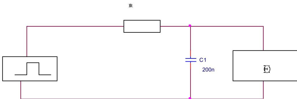
Интегриращата верига използва за изход краищата на кондензатора. Стойностите R и C на елементите на RC верига се избират така, че нейната времеконстанта  $\tau = RC$  да бъде по-голяма. При подаване на сигнали с правоъгълна форма на входа, на изхода се получава трионообразен или триъгълен импулс.
