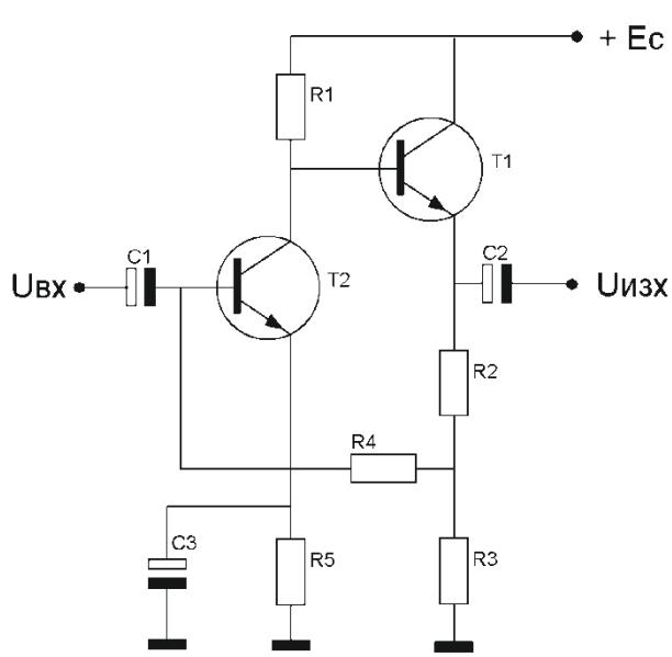
Схемата представлява двустъпален усилвател реализиран с транзисторите  $T_1$  и  $T_2$ .
